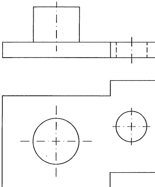
5.- ISOMÉTRICA. Representar en PERSPECTIVA ISOMETRICA, a escala 3:2, la figura correspondiente a las proyecciones. Calcular gráficamente y aplicar en la representación los coeficientes de reducción. Dibujar el perfil correspondiente a la solución hallada.
