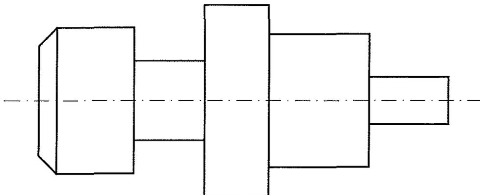
5.- CABALLERA. Representa en PERSPECTIVA CABALLERA, a escala 3:1, la figura dada por sus vistas. El coeficiente de reducción del eje Y es 1/2. La posición de los ejes es la indicada. Dibuja el perfil correspondiente señalado.
